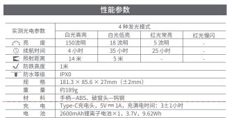
上述参数严格按照Q/GDBCY 020-2019标准,在常温(22 $\pm$ 3°C)环境下测试所得,测试电池 为1×18650 (2600mAh) 锂离子电池,如测试环境不同,性能参数可能会有差异。
